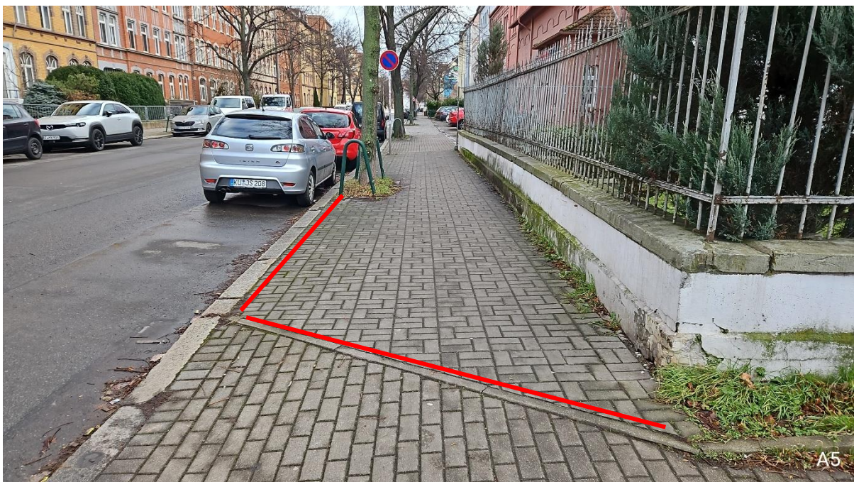
Foto 8 Liebknechtstraße Baum A5 rot = Vorschlag Grenze Bauraum
