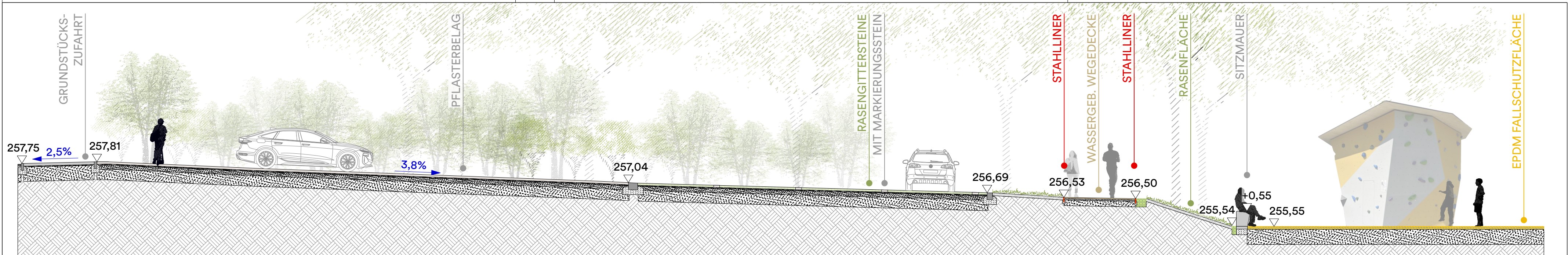
Schnitt A-A' | Grundstückzufahrt - Zufahrtsstraße - Stellplätze - Wassergebundene Wegedecke - Sportfläche / Boulderpyramide | M 1:100
