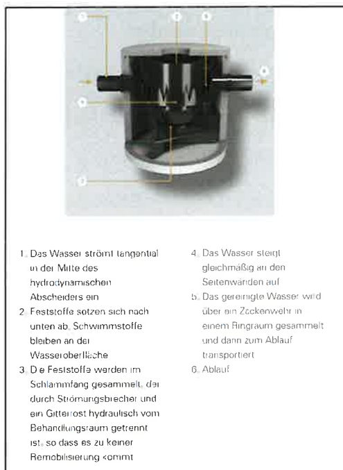
Funktionsweise Sedimentationsschacht:
