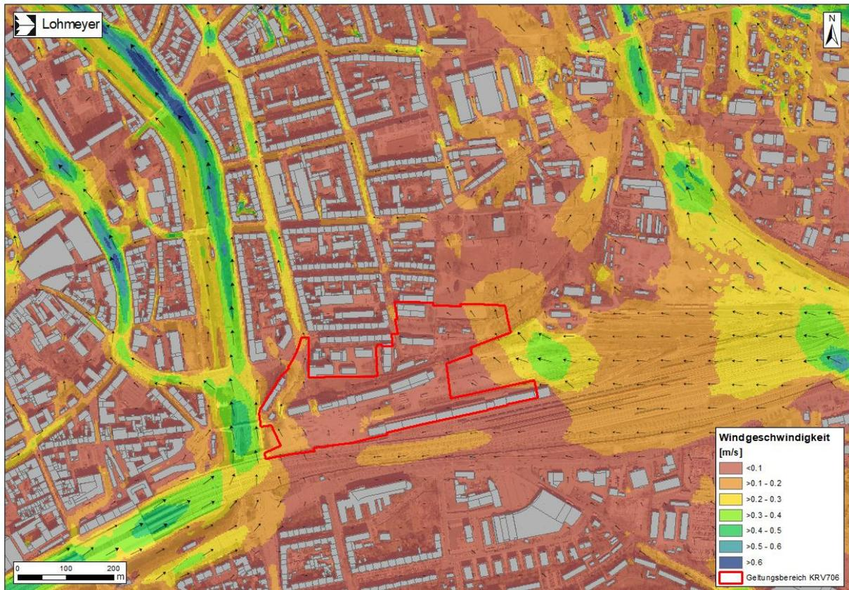
Abb. A2.3: Strömungsgeschwindigkeit in 2m über Grund um 2 Uhr im Analysefall
