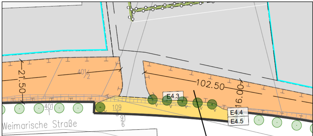
Abbildung 3: Planungsskizze Ein- und Ausfahrt mit Abbiegespur (ohne Maßstab)
