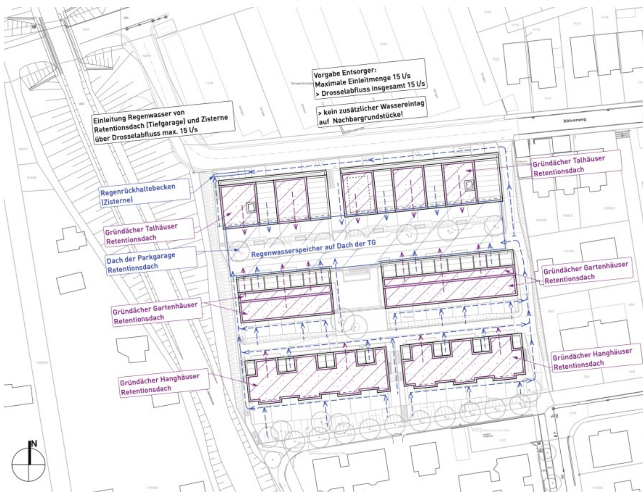
Abb. 5: Grundstücksentwässerungsprinzip, Quelle: Pasel-K Architects
