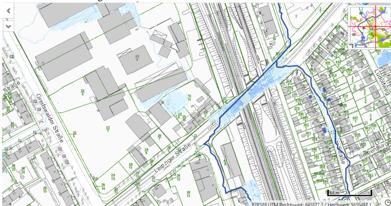
Gemäß DIN 1986:100 ist für Grundstücke über 800 m<sup>2</sup> der Sicherheitsnachweis gegen schadlose Überflutung mit einem mindestens 30-jährigen Regenereignis (Häufigkeit  $n = 0,033 \text{ a}^{-1}$ ) zu führen. Haben Dachflächen und nicht schadlos überflutbare Flächen einen Anteil von über 70 % des Grundstücks, so ist bei der Überflutungsprüfung ein 100-jähriges Regenereignis der Dauerstufe  $D = 5 \text{ min}$  ( $rD, n = r5 \text{ min}; 0,01$ ) anzusetzen.
