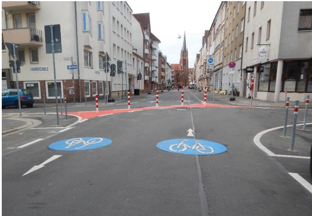
Abb. 3-2: Modaler Filter in Fahrradstraße (Hannover, Quelle: PGV-Alrutz)
