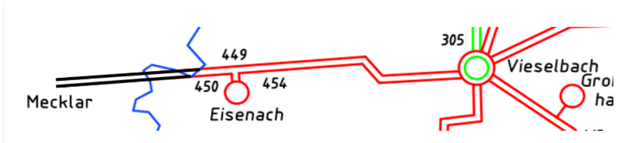
Abbildung 2: Aktueller Verlauf der 380-kV-Freileitung Vieselbach – Eisenach – Mecklar (Quelle: 50Hertz)
