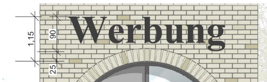
Abb.: korrigierte Vermaßung im Fassadendetail
