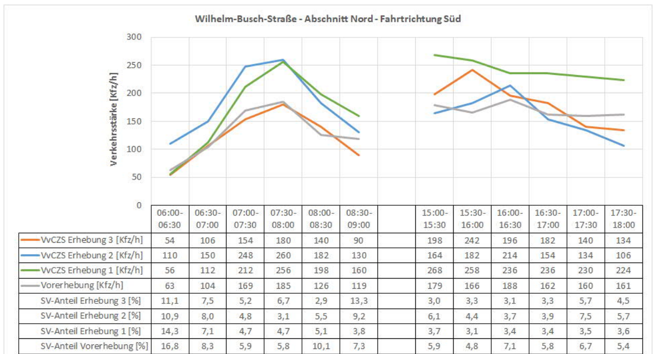
Abb. 3.5: Verkehrserhebung Wilhelm-Busch-Straße – Abschnitt Nord – Fahrtrichtung Süd
