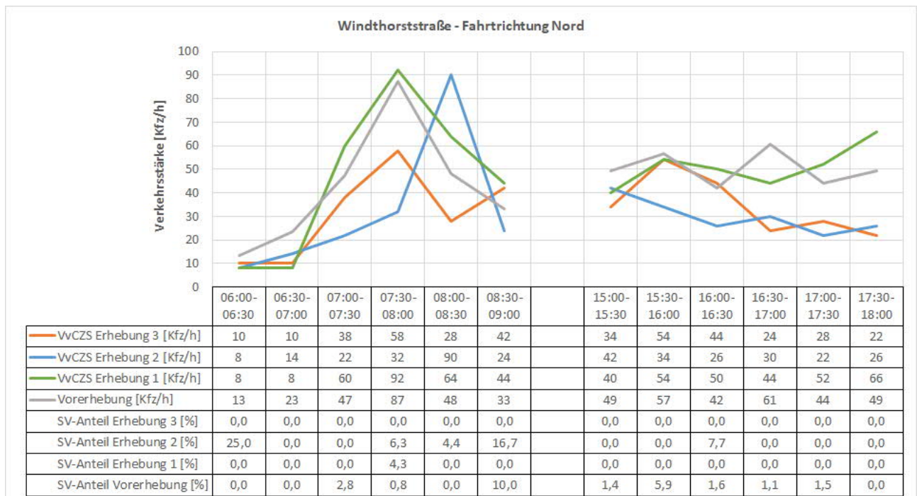
Abb. 3.8: Verkehrserhebung Windthorststraße – Fahrtrichtung Nord
