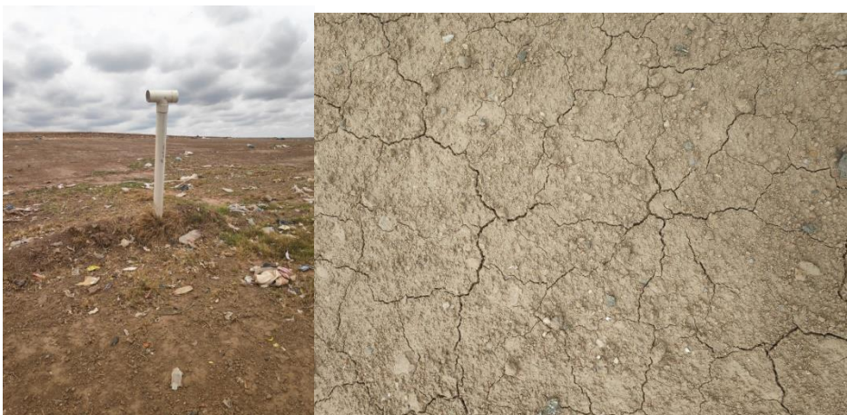
Abbildung 9: Rohre über die das Deponiegas entweicht (links) / Deponiegase entweichen auch über den Boden (rechts)
