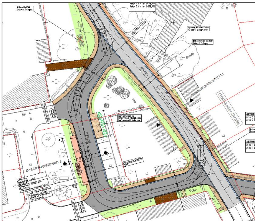
Abb. 13 Schleppkurve Gelenkbus - EVAG -
