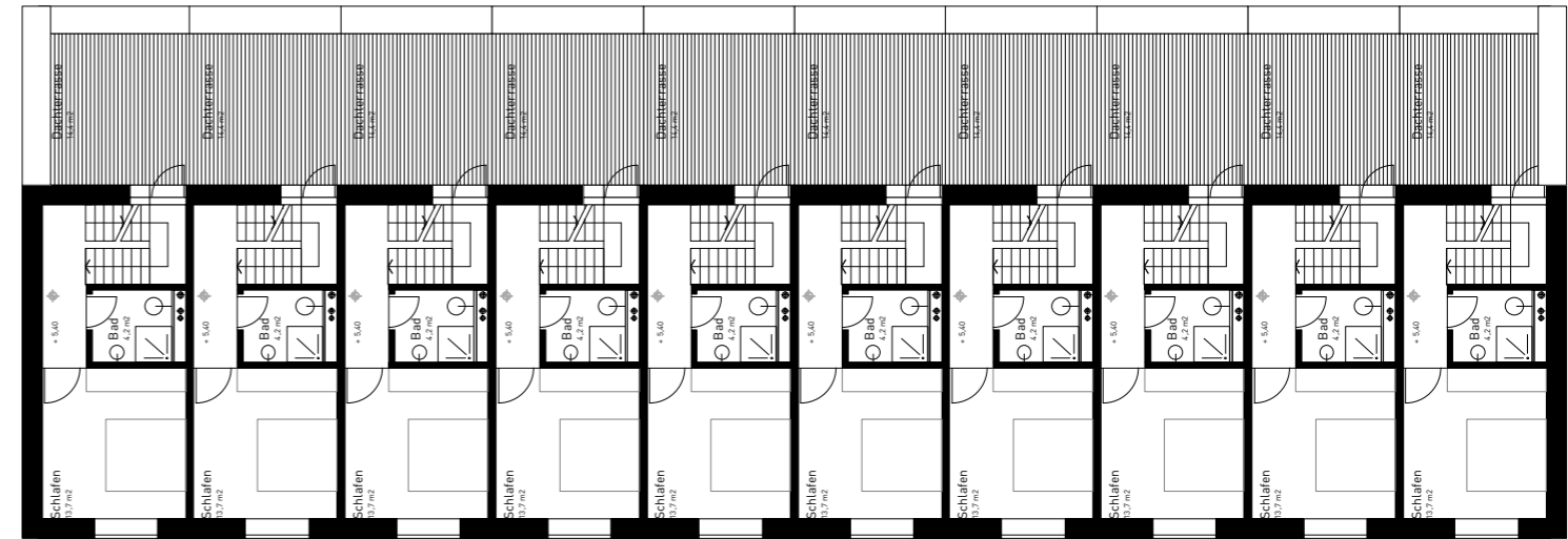
GARTENHÄUSER Grundrisse 1. Obergeschoss M 1:200
