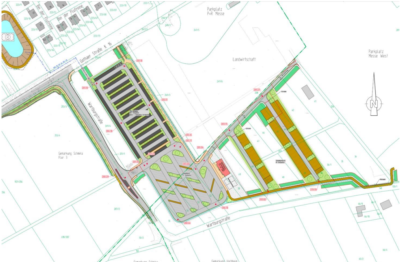
Bild 80: Vorplanung der Stadt Erfurt für die Anlage von Parkplätzen in der Nachbarschaft des bestehenden P+R-Platzes Messe (Arbeitsstand 12.02.2019)
