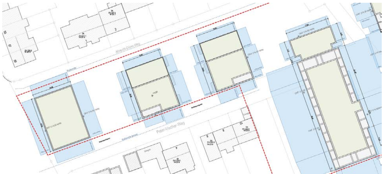
Abb.: Übersichtsplan der bauordnungsrechtlich erforderlichen Abstandsflächen, Stand 10.12.18 Junk & Reich Architekten Planungsgesellschaft mbH, Auszug, unmaßstäbliche Verkleinerung
