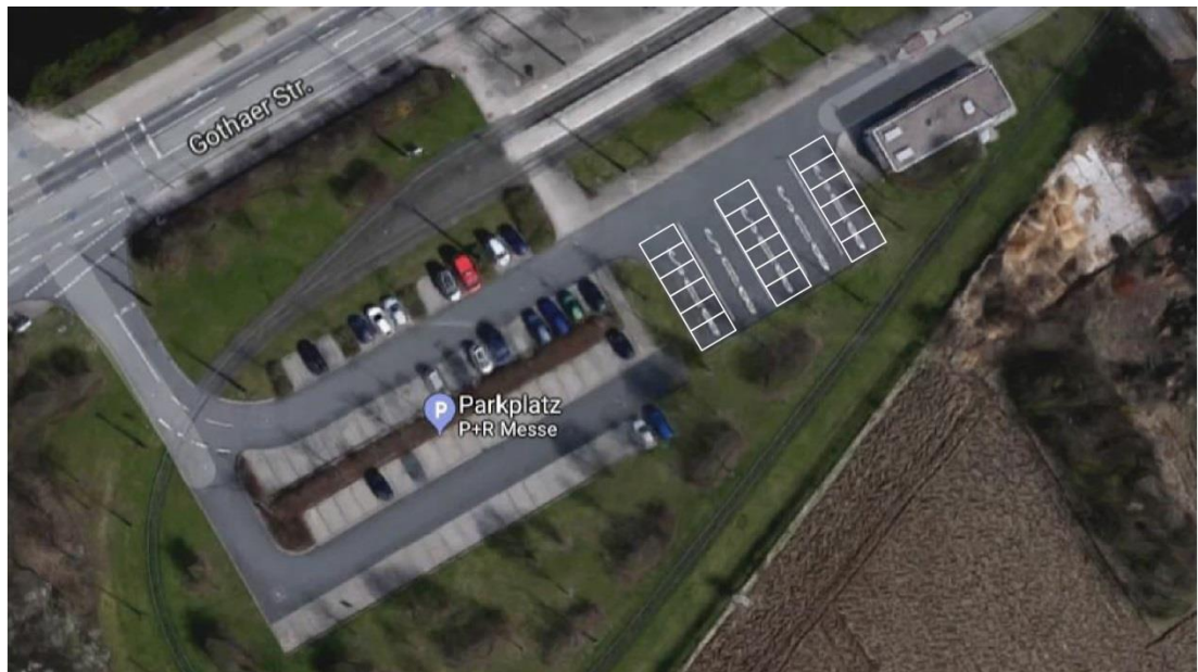
Bild 110: Mögliche Sofortmaßnahme zur Erweiterung des bestehenden P+R-Platzes Messe durch Ummarkierung der Busstellplätze in Pkw-Stellplätze (Quelle Grundlage: Google)
