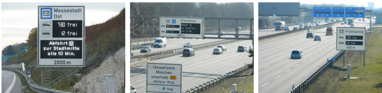
Bilder 116 bis 118: Dynamische P+R-Wegweisung an Autobahnen um München, A 941 links, A 9 Mitte und rechts (Fotos: Frank Zöttl, Olching)
