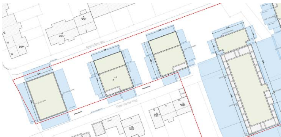
Abb.: Übersichtsplan der bauordnungsrechtlich erforderlichen Abstandsflächen, Junk & Reich Architekten Planungsgesellschaft mbH, Auszug, unmaßstäbliche Verkleinerung, Stand 10.12.18
