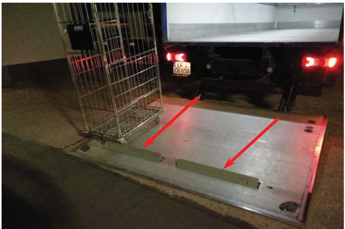
Foto 12: Blick auf die „Abrollsicung“ auf der Ladebordwand der Lkw, die beim Herunterklappen mit dem Fuß des Fahrers stark impulshaltige Geräuschemissionen erzeugt.
