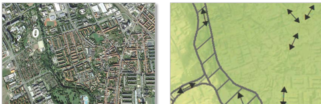
Abbildung 56: Durchlüftungsbahn am Beispiel der Geraaue, der Magdeburger Allee und Gleisanlagen (der Strecke Erfurt – Nordhausen): Luftbild (links) und DGM-Ausschnitt aus der dynamischen Klassifizierung der Klimafunktionskarte (rechts, Legende in Kapitel 7.2); farbliche Kartengrundlage: Digitales Oberflächenmodell (rechts)
