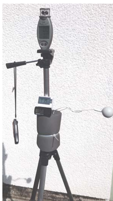
Abbildung 36: Mobile umweltmeteorologische Messstation.
