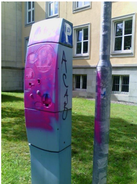
Abbildung 7: Beispiel für Vandalismus-Schaden Parkscheinautomat
