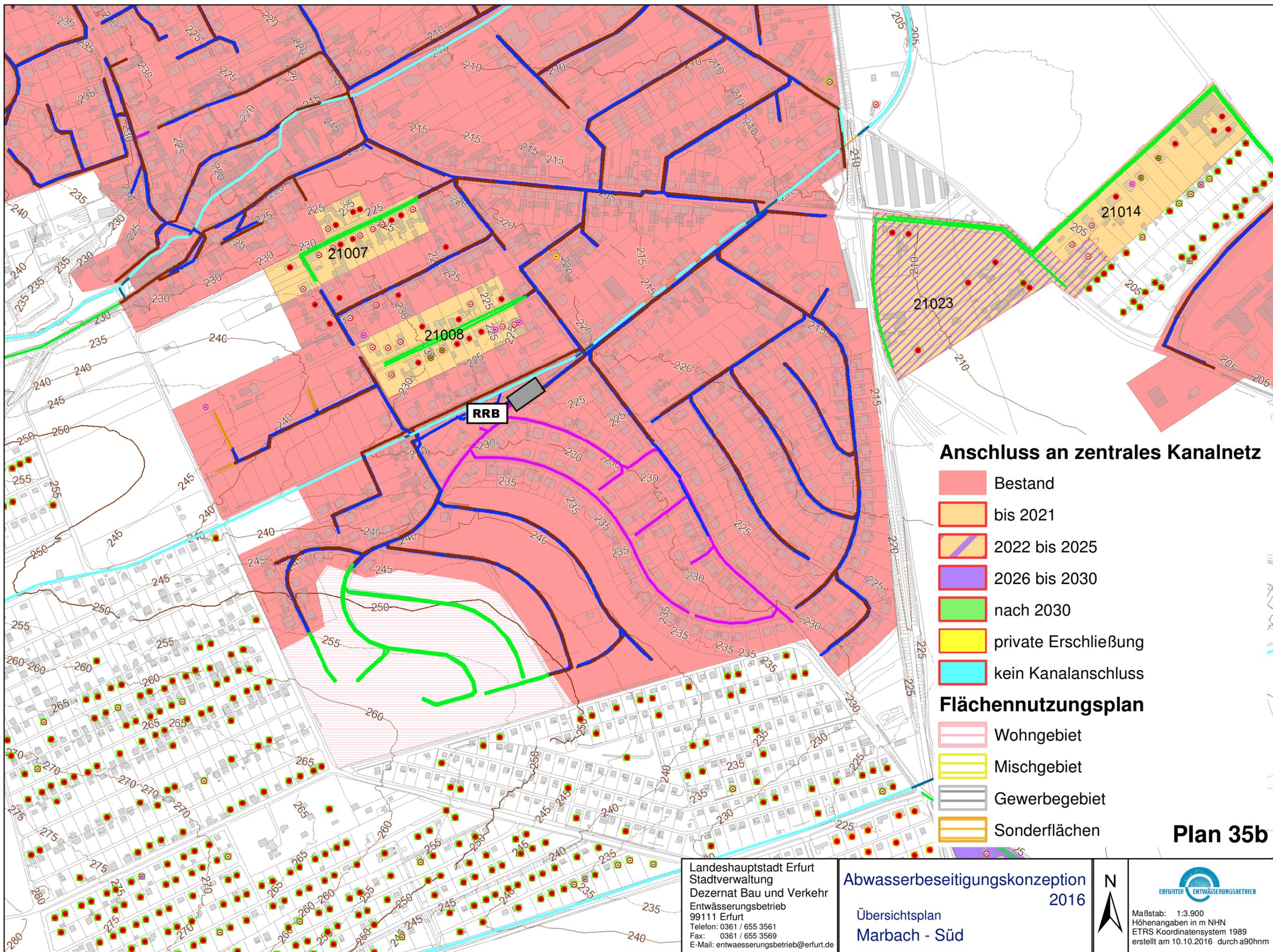
**Anschluss an zentrales Kanalnetz**
