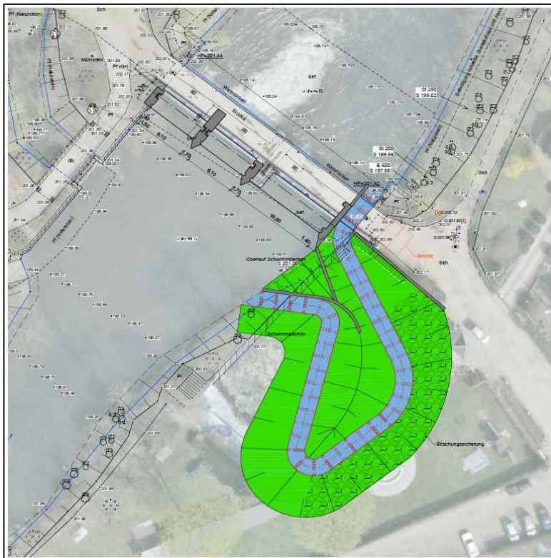
Abbildung 12: Wehrsanierung naturnahe Lösung, Untervariante 2.1, Vollabbruch der Gebäude
