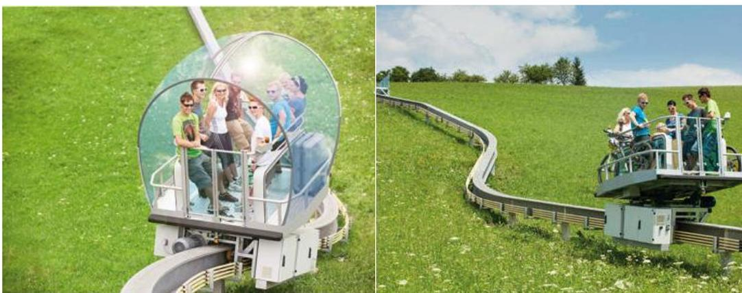
Abbildung 10: Mountainstepper auf Kranschiene
