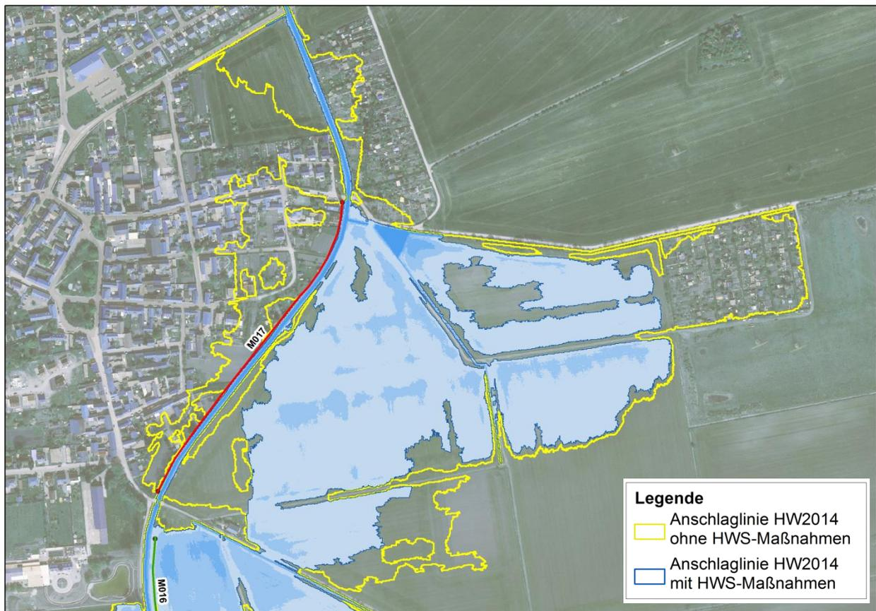
Abbildung 8-24 HW 2014 mit Hochwasserschutzmaßnahmen, Kerspleben
