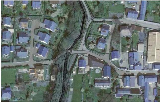
*Bruchkanten des Flussschlauchs*
