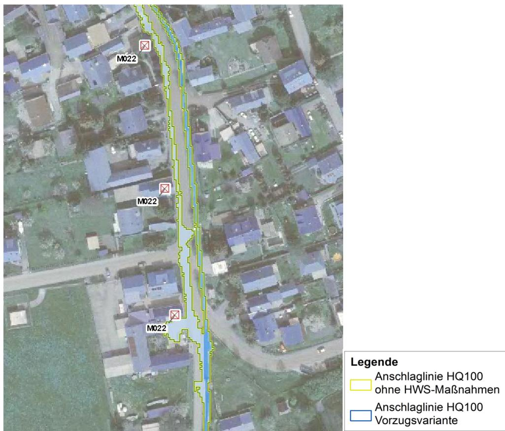
Abbildung 8-4 Niedernissa, Objektschutz für die gekennzeichneten Gebäude
