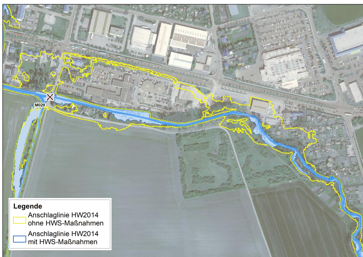
Abbildung 8-19 HW 2014 mit Hochwasserschutzmaßnahmen, Linderbach Weimarische Straße
