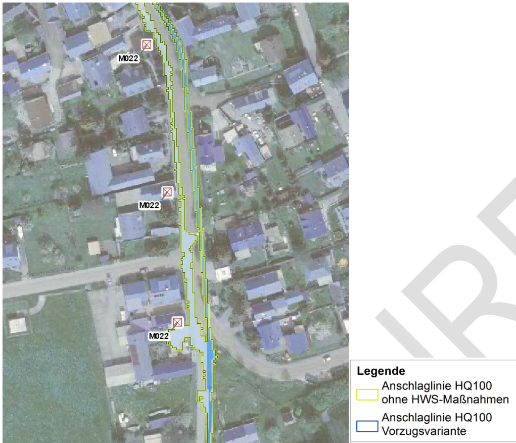
Abbildung 8-3 Niedernissa, Objektschutz für die gekennzeichneten Gebäude
