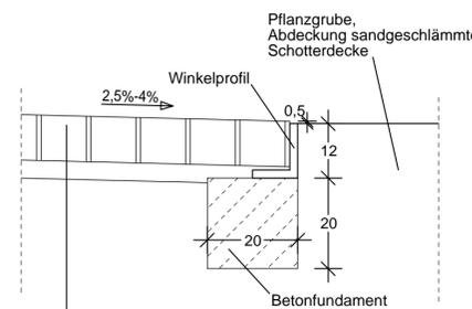
Gehbahn, Aufbau nach RStO 12, Tafel 6, Zeile 1
