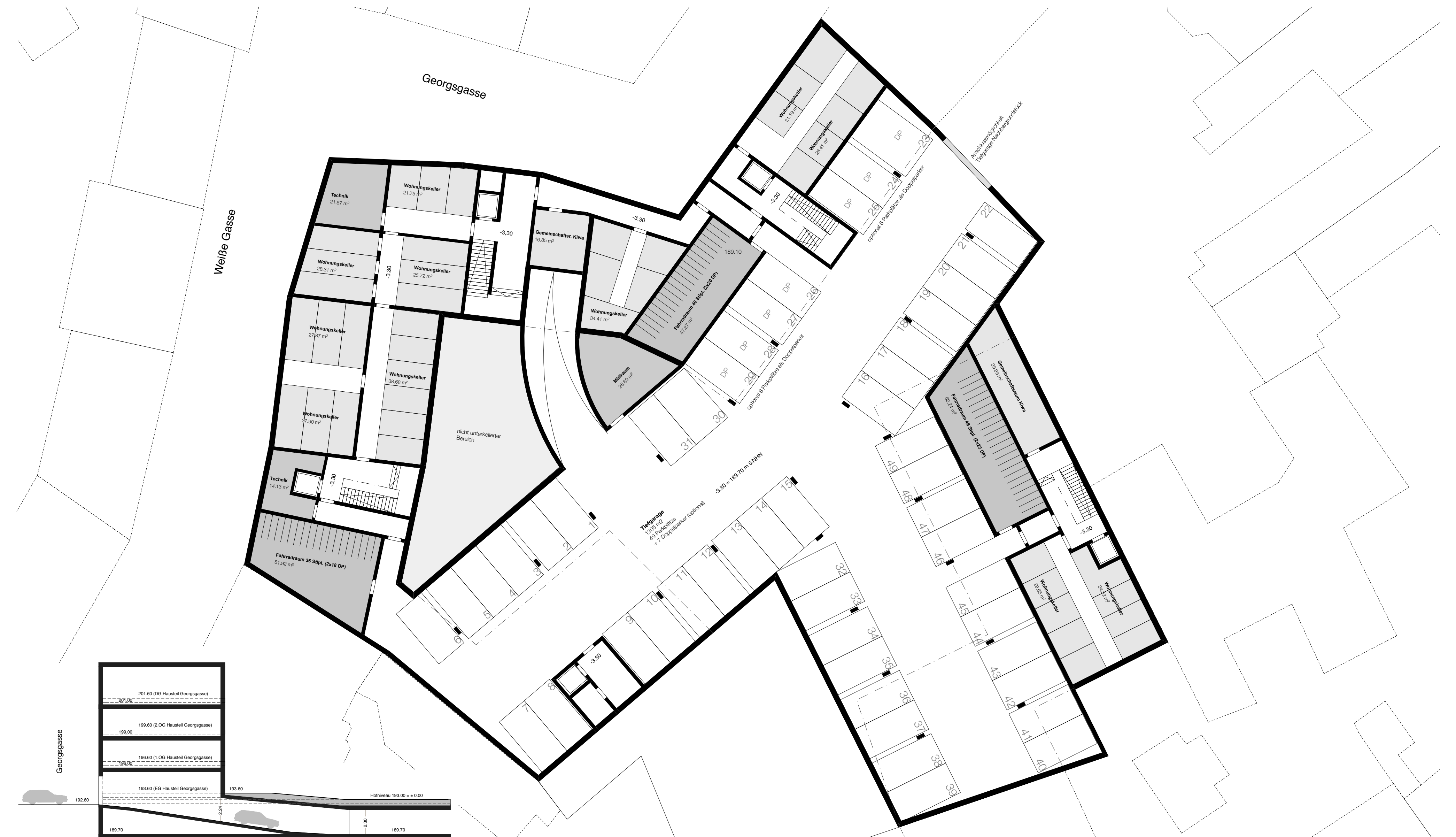
Grundriss Untergeschoss mit Tiefgarage M 1:200 / Schemaschnitt M 1:250
