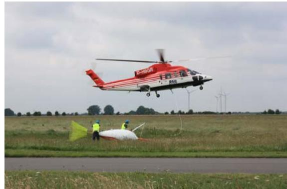
Datenerfassung aus der Luft mit neu entwickeltem SQUID-Gradiometer im Sommer 2012
