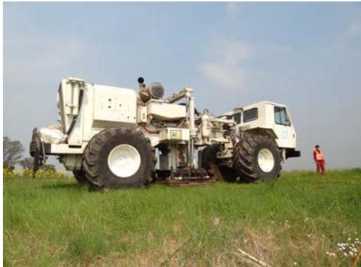
Seismische Messungen entlang von drei festgelegten Profillinien mit einem Vibratorfahrzeug im Frühjahr 2011
