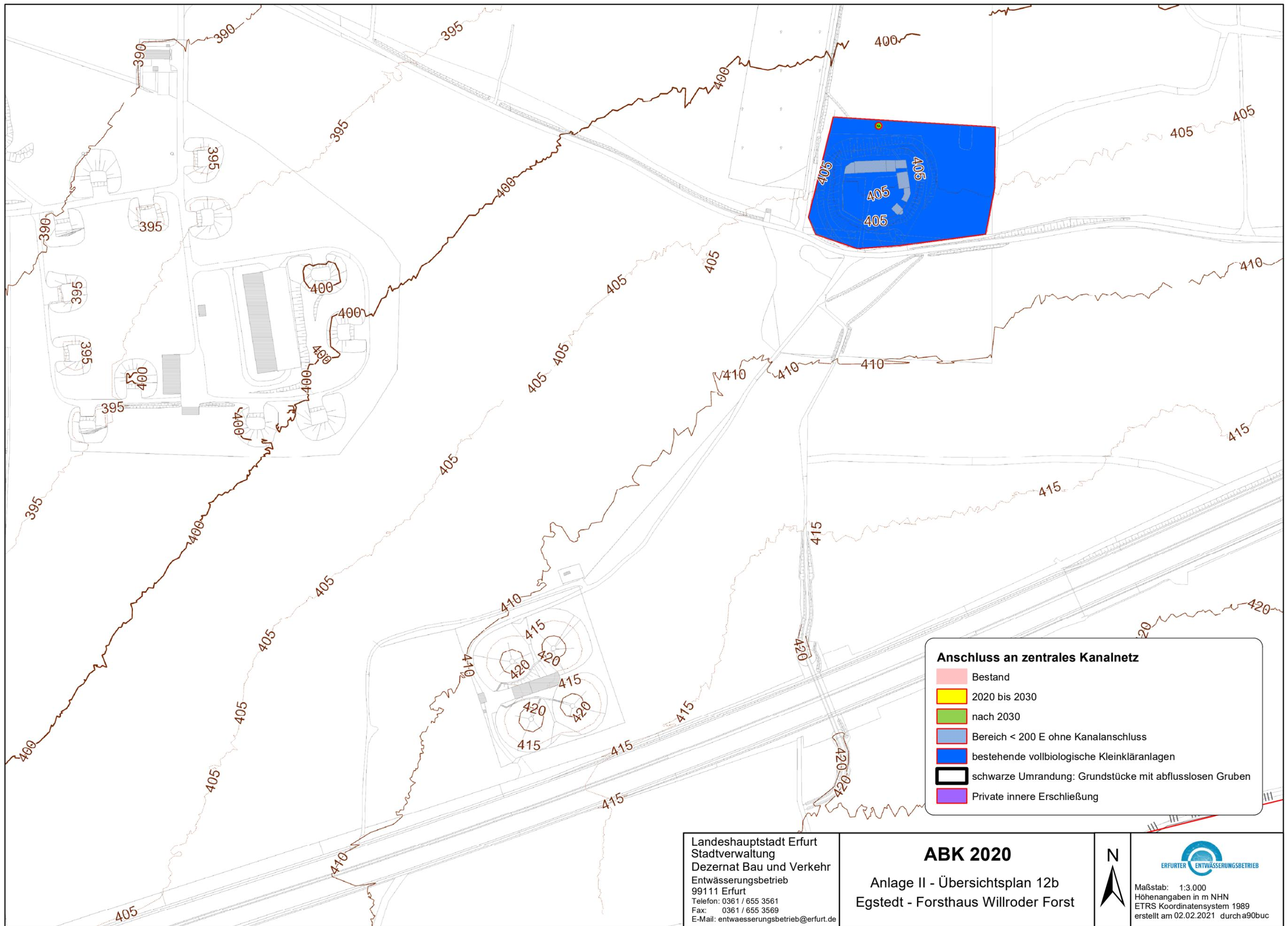
**Anschluss an zentrales Kanalnetz**
