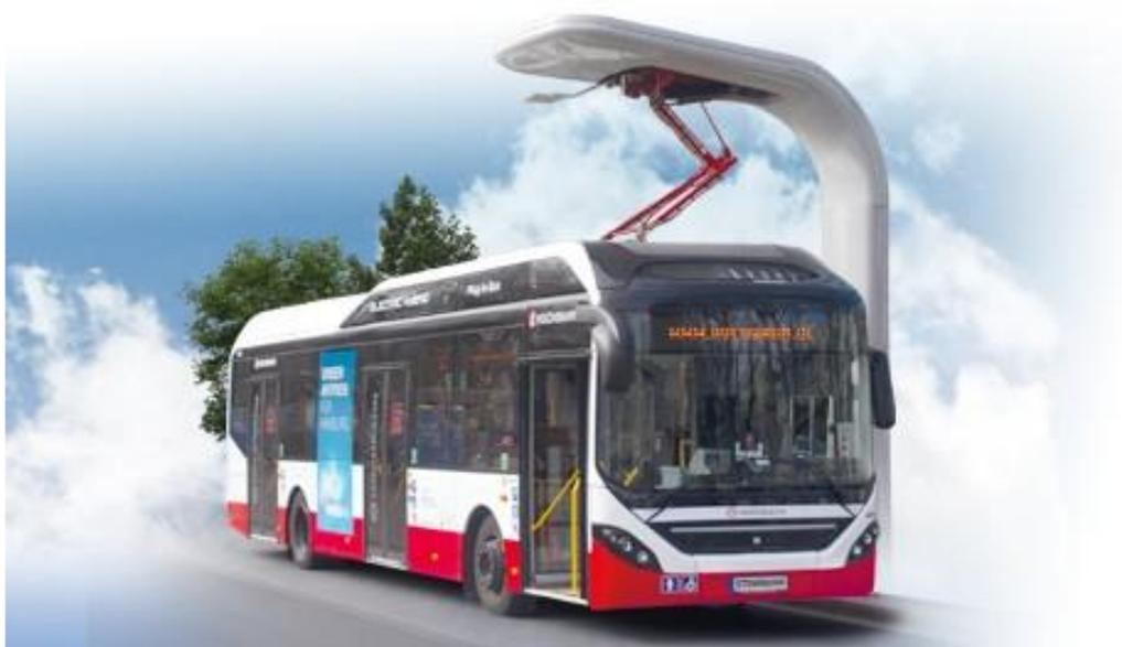
Abbildung 31: Schnelllade-Docking-Station mit Ladepantograph [ST 2019]
