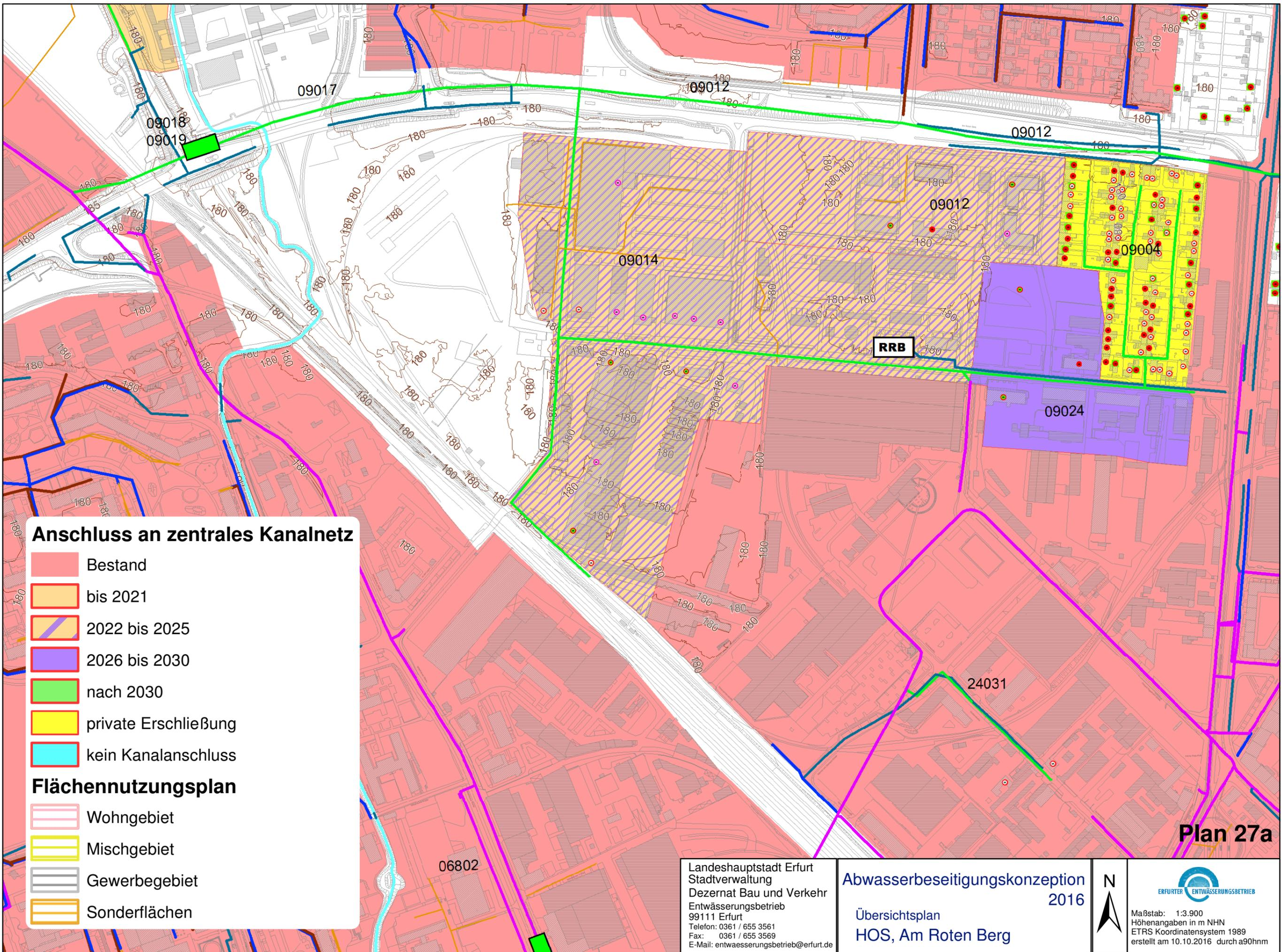
**Anschluss an zentrales Kanalnetz**
