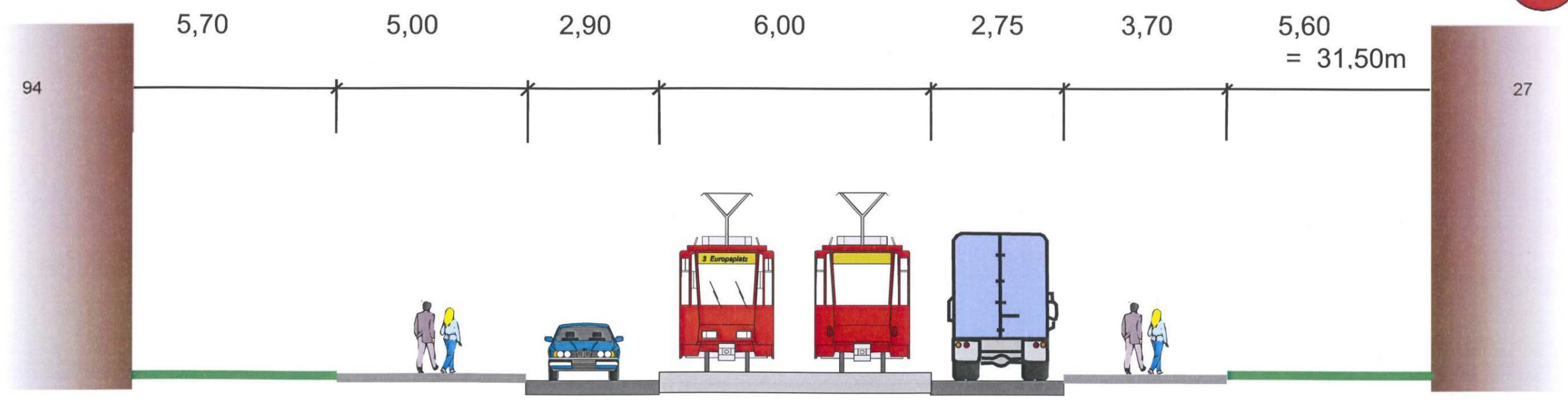
Abb. 1: derzeitiger Zustand - besonderer Bahnkörper
